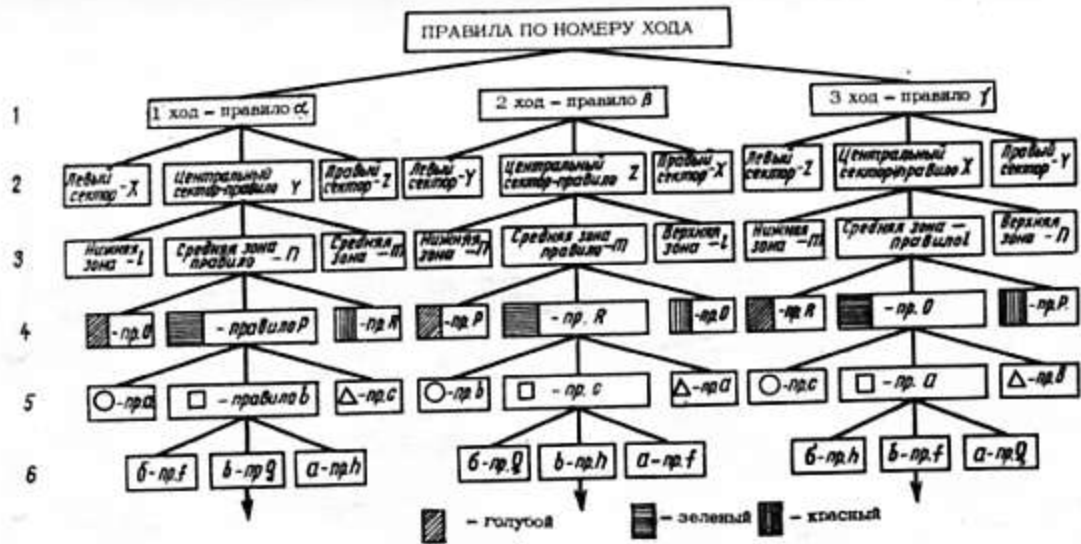
Рис. 1. Мнемосхема дерева правил с коэффициентом иерархичности, равным 3
